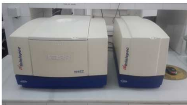
Figure 2 : photo du spectromètre à résonance magnétique nucléaire (RMN) basse résolution Type (minispec mq 20, Germany).
