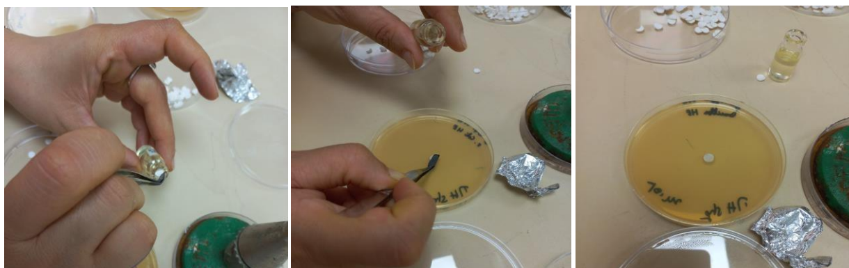
Figure n° 05. Photographies montrant le prélèvement et la pose des disques imbibés d'huile essentielle (originale, 2022)
