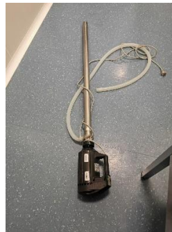
Figure : Pompe de transfert mobile
