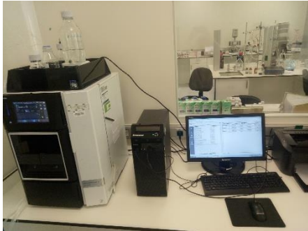
Figure : HPLC, (colonne octadécylsilylé c 18 (25 cm ~ 4,6 mm ~ 5 \mu m) Thermo Scientific Hypersil Gold ou équivalent))
