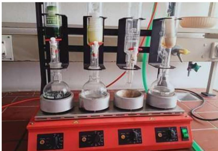
**Figure 07.** Extraction des HAP à l'aide de Soxhlet
