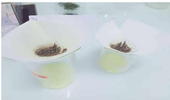
Figure 09 : Filtration des échantillons avec papier Wattman
