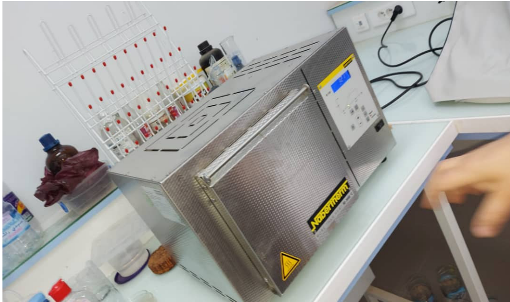
Figure A2 : four à moufle de type Nabert hem
