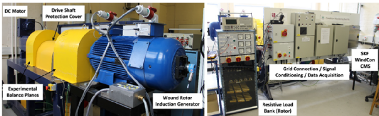
Fig. 3.1. Banc d'essai d'une génératrice éolienne dédié pour le diagnostic des défauts [32].
