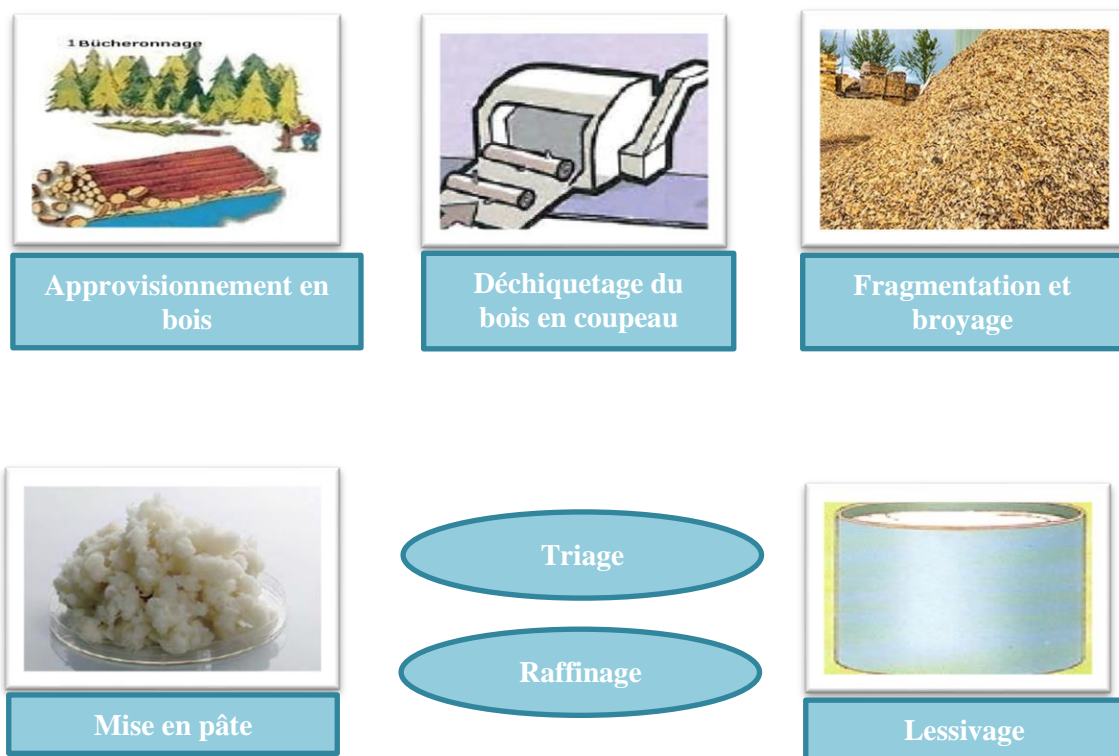
Figure n° 01 : Schéma représentatif du cycle de fabrication de la pâte à papier
