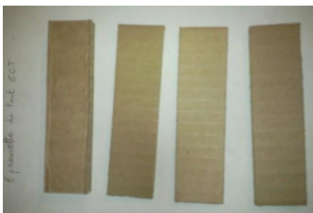
Figure n°18 : Eprouvettes pour test ECT
