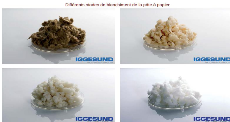
Figure n° 02 : Différents stades de blanchiment de la pâte à papier [9]
