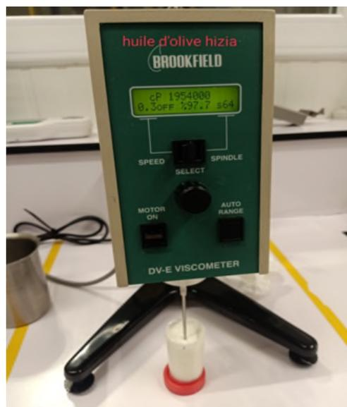
**Figure 4 : Photographie du Brookfield DV-E Viscosimeter**
