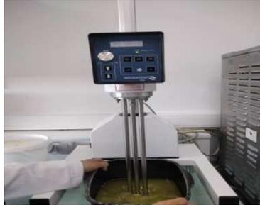
**Figure 19:** Homogénéisation du mélange HE avec l'appareil high shear
