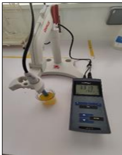
Figure 7: pH mètre de marque HACH .
