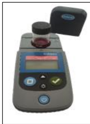
Figure 8: Colorimètre de marque HACH
