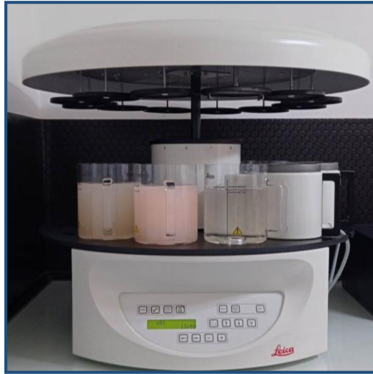
Figure 5 : Photographie originale de l'automate de circulation et de déshydratation.
