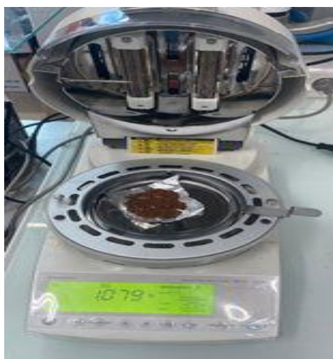
Figure 5: Détermination de taux d'humidité des substrats par dessiccateur infra-rouge.
