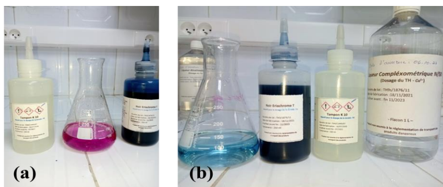
Figure 9. Photos montrant la détermination de la dureté totale : (a) avant titrage avec EDTA et (b) après titrage avec EDTA (cliché Ouddak & Ghebrioua, 2023).
