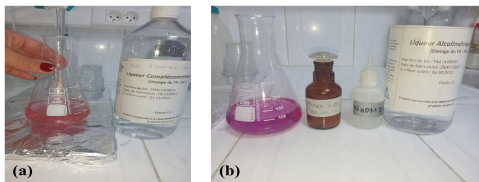
Figure 10. Photos montrant la détermination du calcium : (a) Avant titrage avec EDTA et (b) Après tirage avec EDTA (cliché Ouddak & Ghebrioua, 2023).
