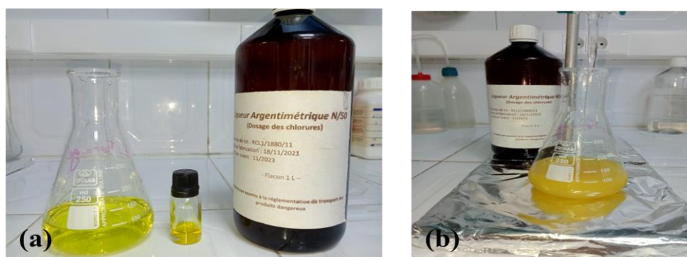
Figure 11. Photos montrant la détermination de chlorure: (a) Avant titrage et (b) Après tirage avec du chromate de potassium K_2CrO_4 (cliché Ouddak & Ghebrioua, 2023).
