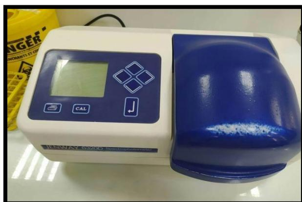
Photographie d'un spectrophotomètre à cuves générale (Jenway 6 320).
