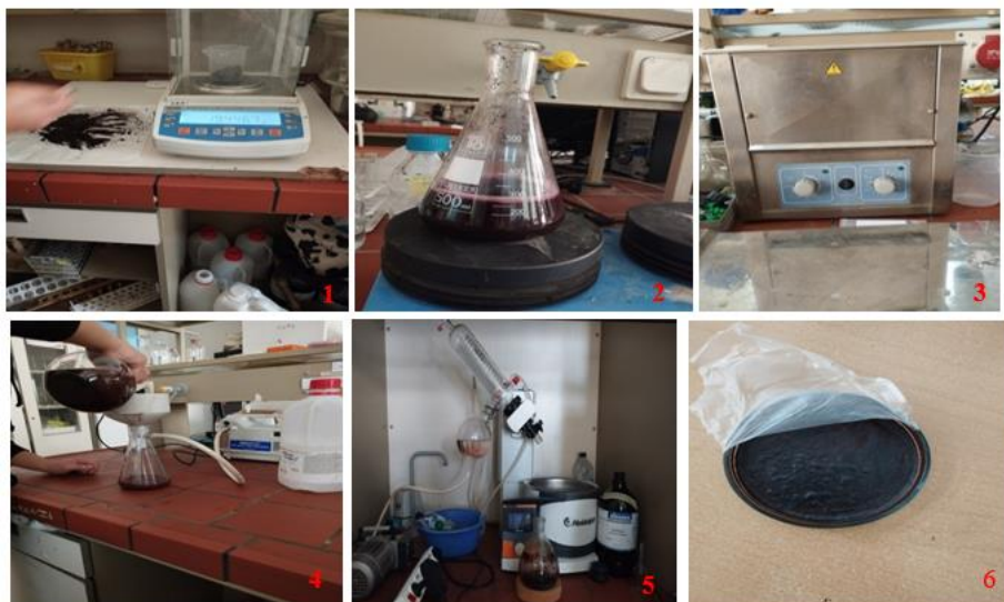
Figure 12 : les différentes étapes d'extraction des composées phénoliques de fruits de P.lentiscus (Original).
