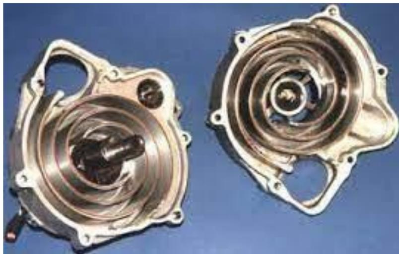
**Figure I.5 :** Compresseur à spirale
