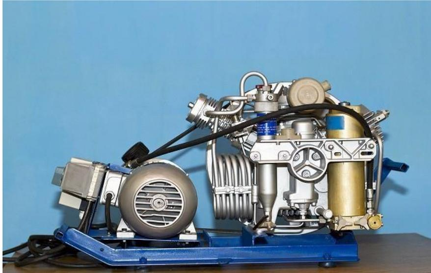
**Figure I.4 :** Compresseur à piston
