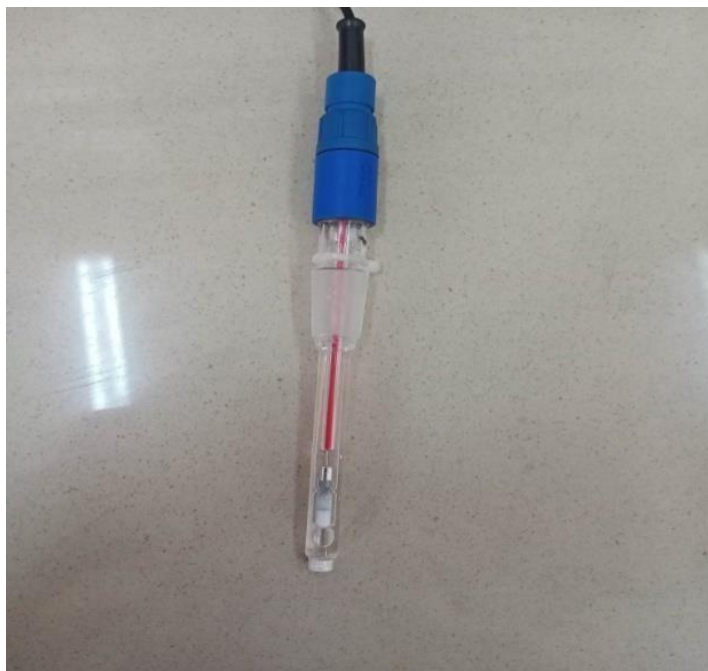
Figure II.6. Électrode de référence (ER)
