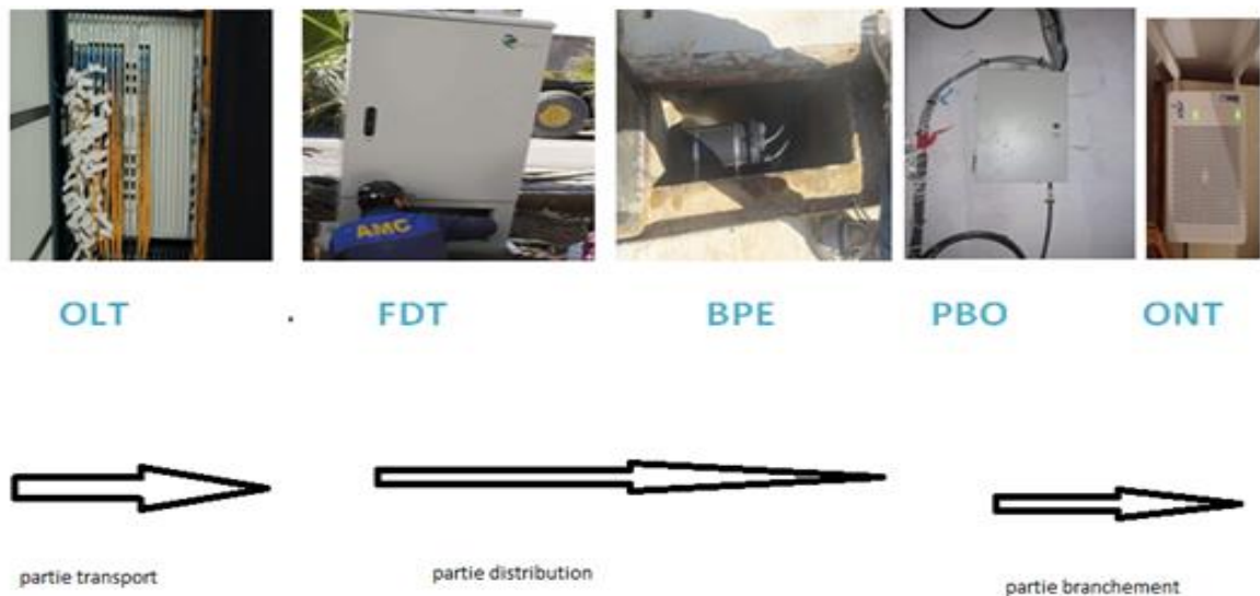
Figure 2-1 : Schéma d'un enchaînement des Equipment FTTH
