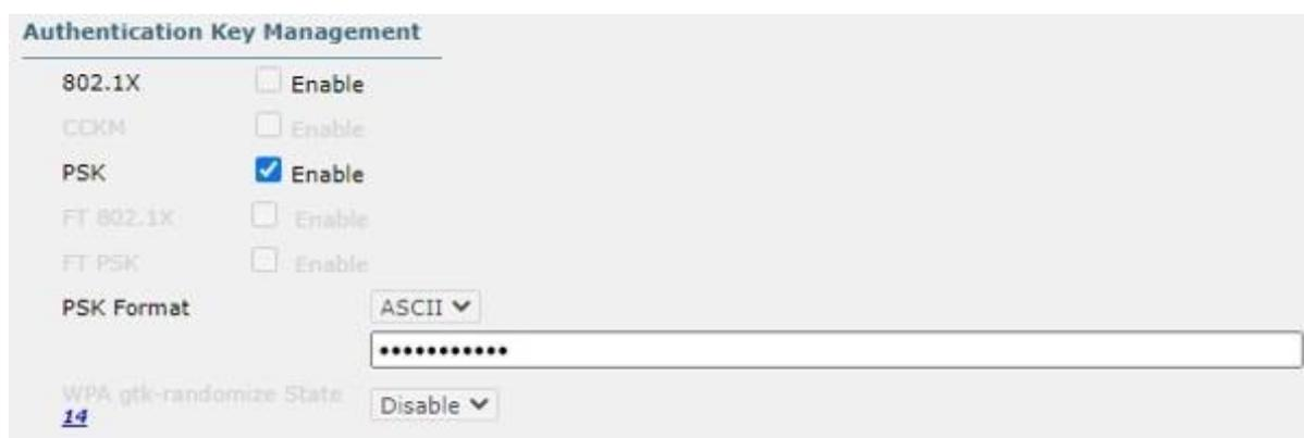
FIGURE 4.5 – configuration d'un mot de passe au point d'accès depuis un contrôleur
