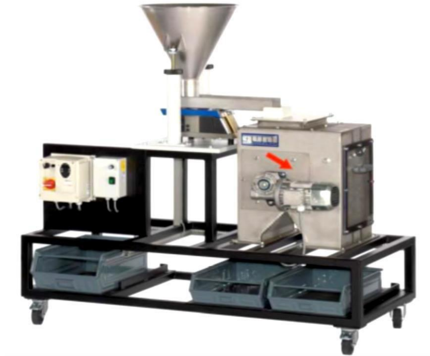
Figure III.8 : Séparateur magnétique à basse intensité modèle de laboratoire de Mines et géologie
