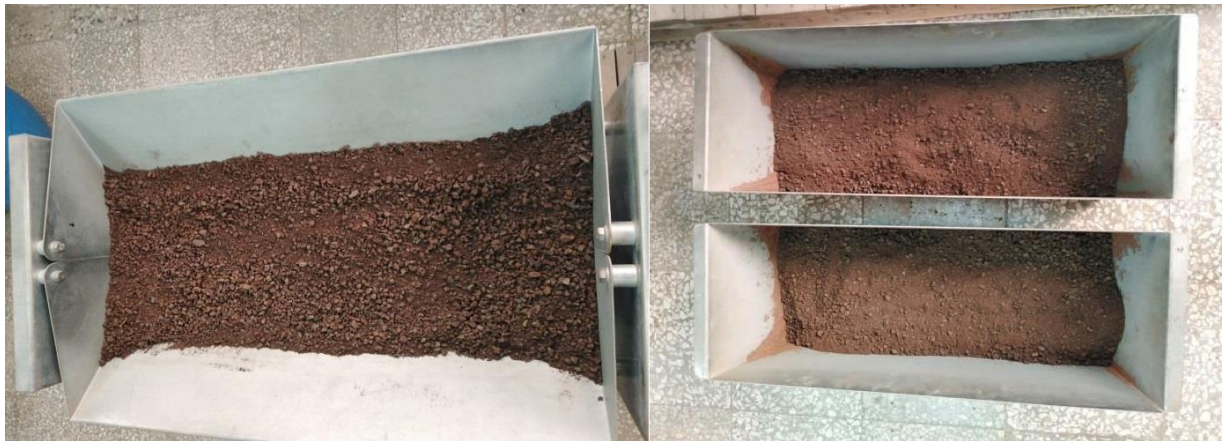
Figure III.4 : Division de minerai de fer de sidi maarouf dans laboratoire de Mines et Géologie
