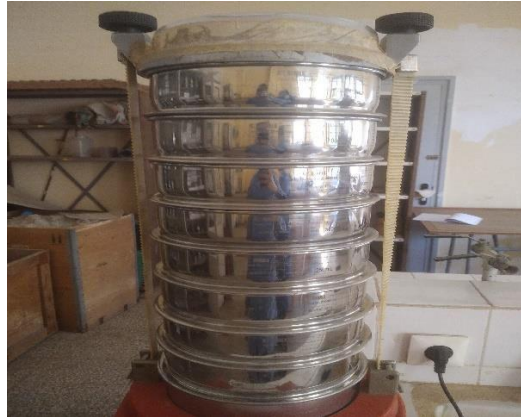
Figure III.6 : Tamiseur de Type FRITSCH de laboratoire de Mines et Géologie
