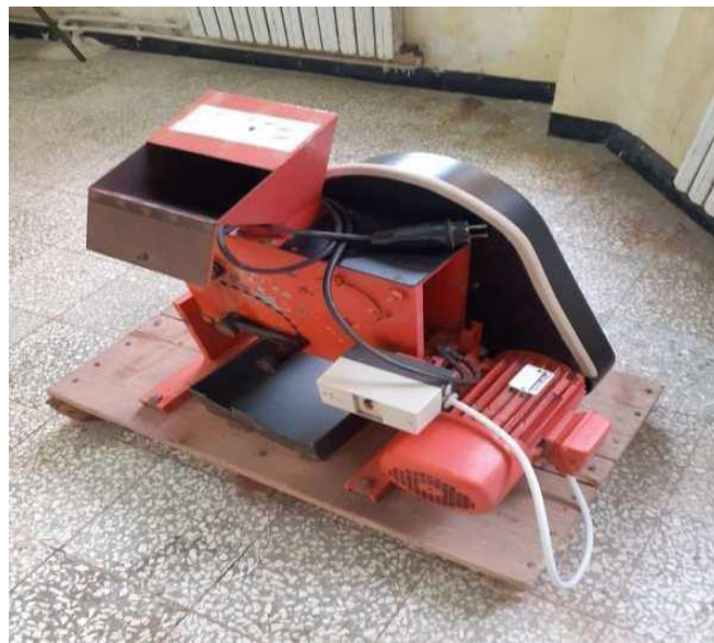
Figure III.3 : Image de concasseur à mâchoire de laboratoire de Mines et Géologie
