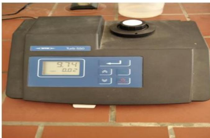
Figure III.5. Turbidimètre [1].
