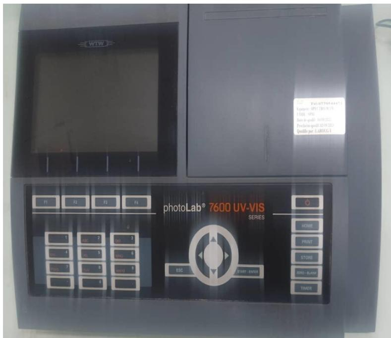
Figure III.7. Spectrophotomètre 7600UV-VIS (23.05.2023) [14]
