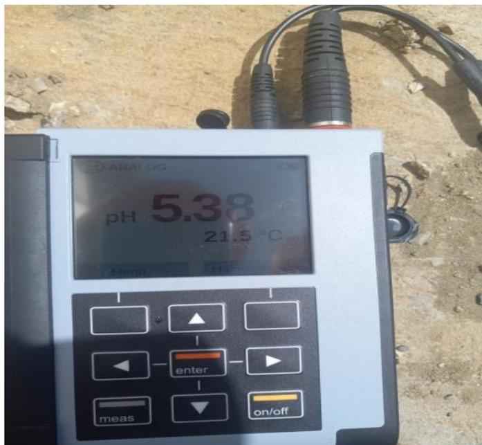
Figure III.3 : pH mètre multifonctions
