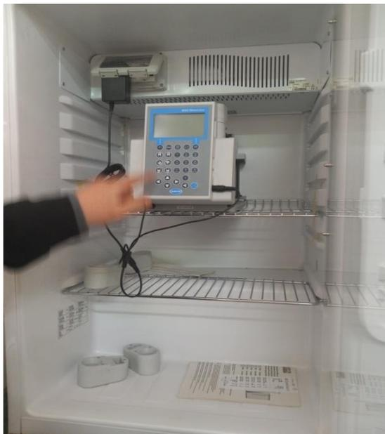
Figure III.8 : un analyseur de la demande biochimique en oxygène
