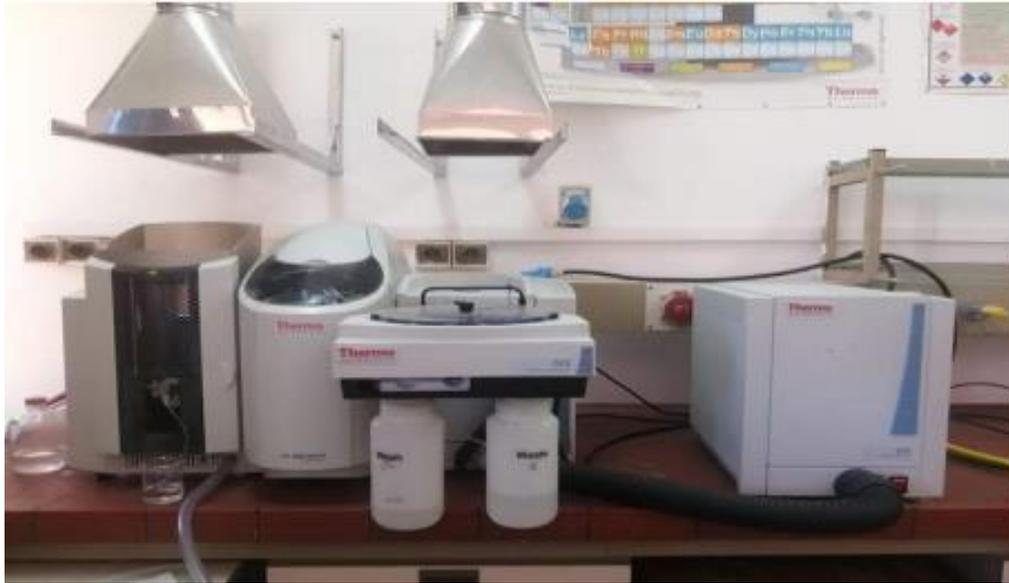
Figure III.11 : spectrométrie d'absorption atomique. [1]
