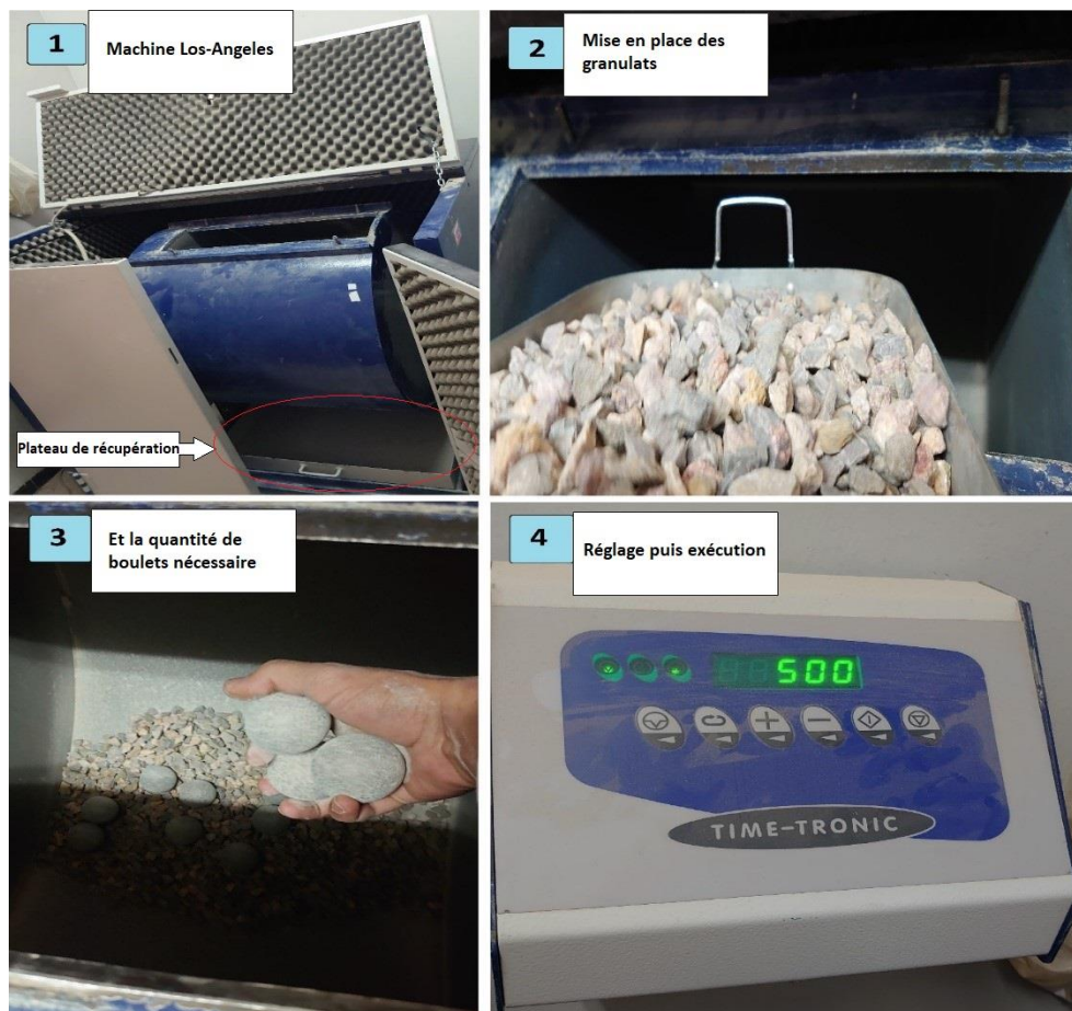
Figure II-7 : Exécution de l'essai Los Angeles (photos prises en Avril 2023)
