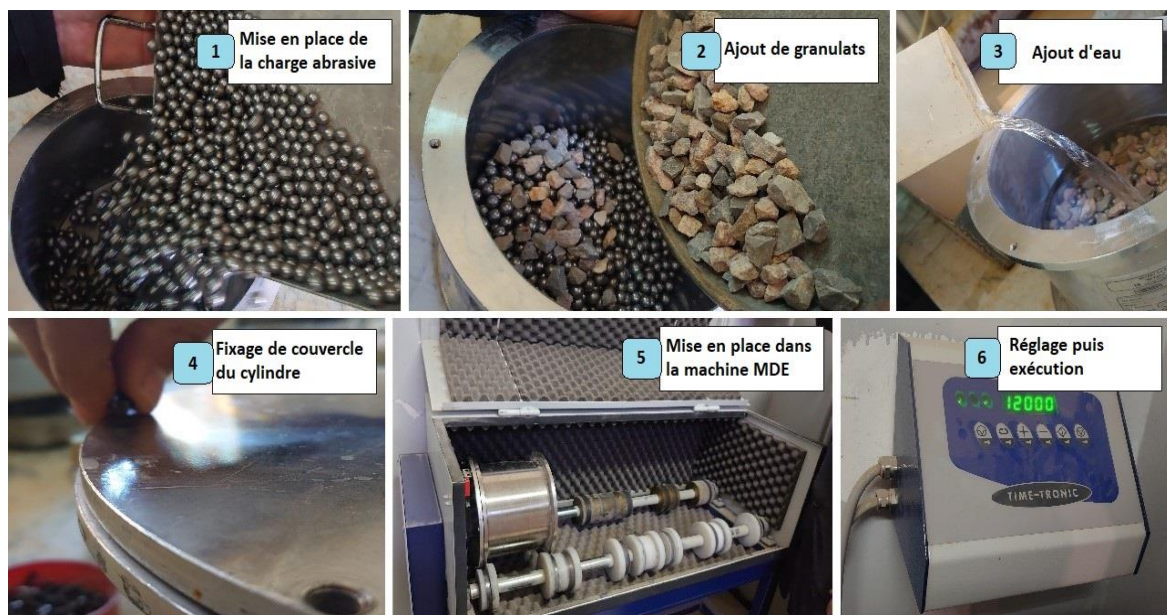
Figure II-6 : Exécution de l'essai Micro-DEVAL (photos prises en Avril 2023)
