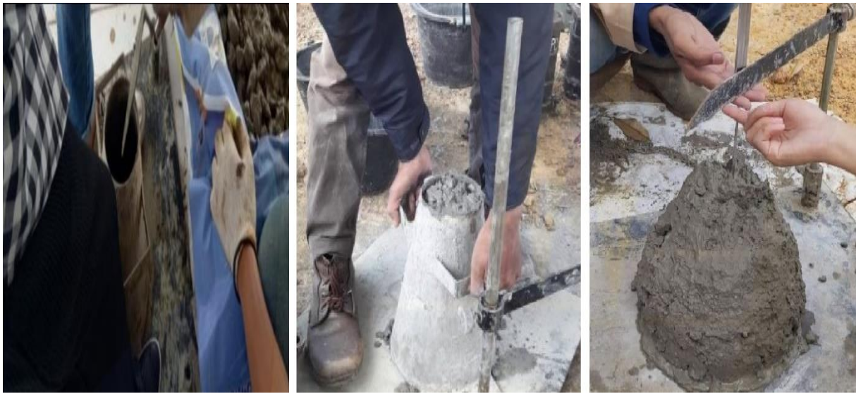
Figure II-11 : Exécution de l'essai d'affaissement au cône d'ABRAMS
