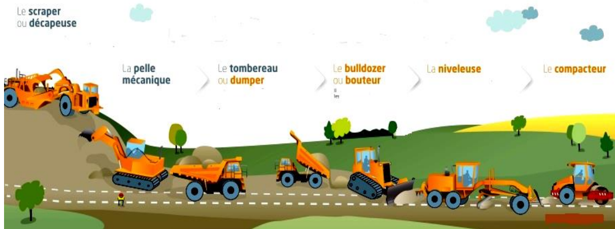
Figure IV.4 : Dessin représentant l'ensemble des engins des travaux mécaniques. [25]
