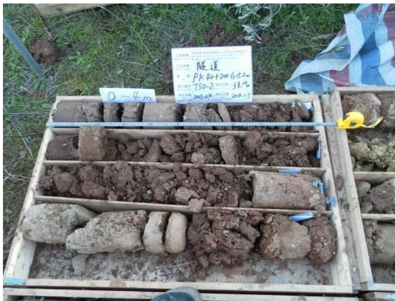
Figure II. 9 Argile peu plastique, dure. [26]
