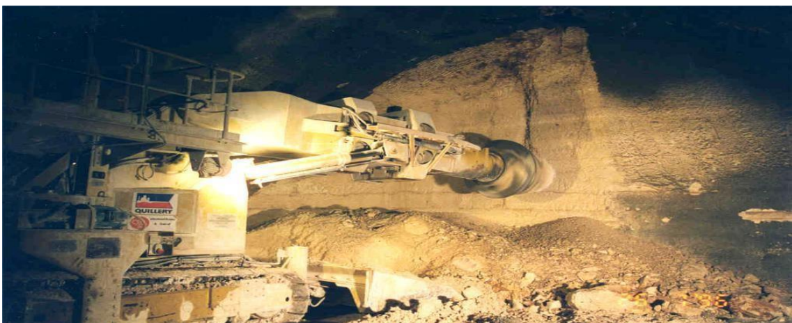
Figure I. 13 Machines à attaque ponctuelle (Extrait de la brochure de Wirth). [17]
