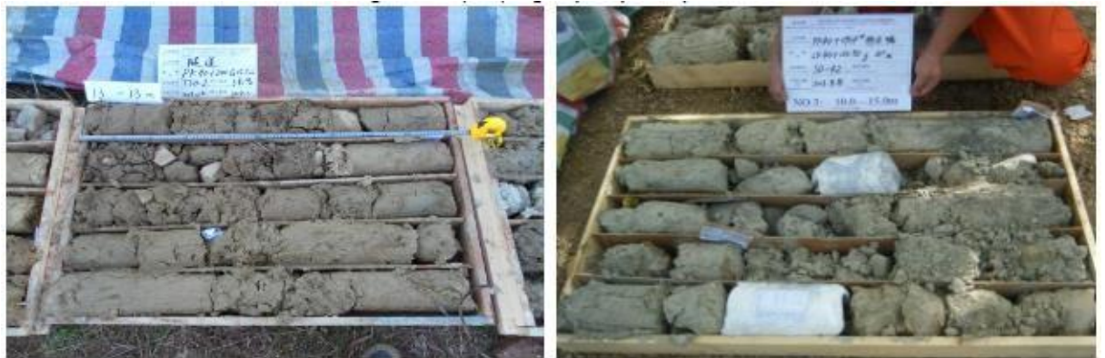
Figure II.11 Marne totalement altérée.
