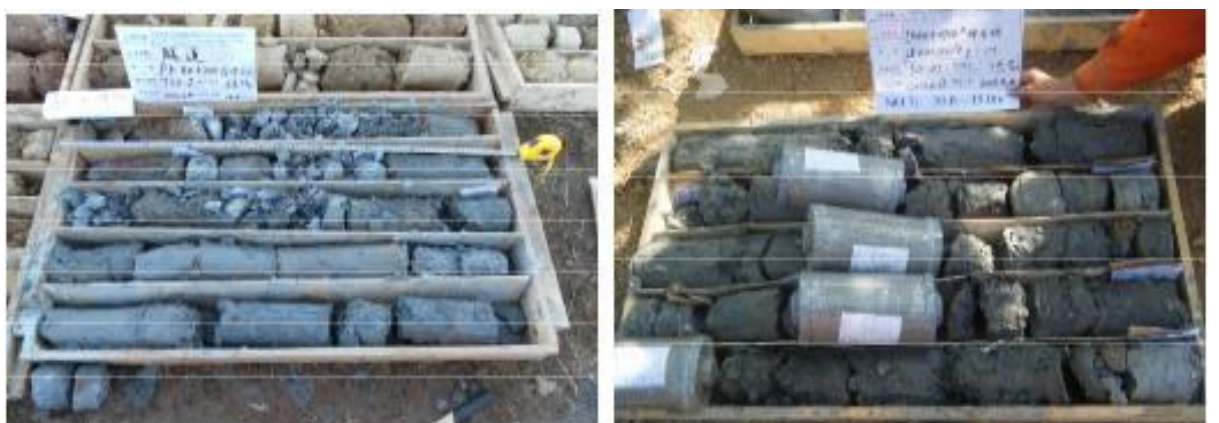
Figure II.13 Marne intensément altérée
