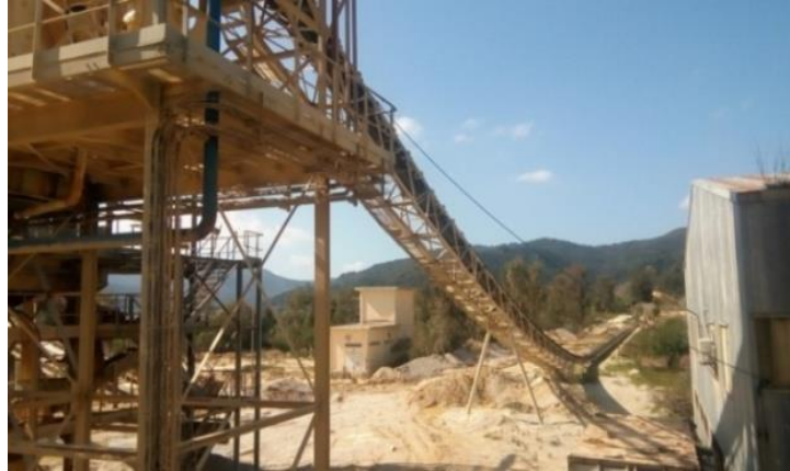
Figure II.3. Bande navette d'alimentation de l'usine en Kaolin brut.
