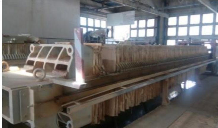
FigureII.6. Filtre presse et séchoir.
