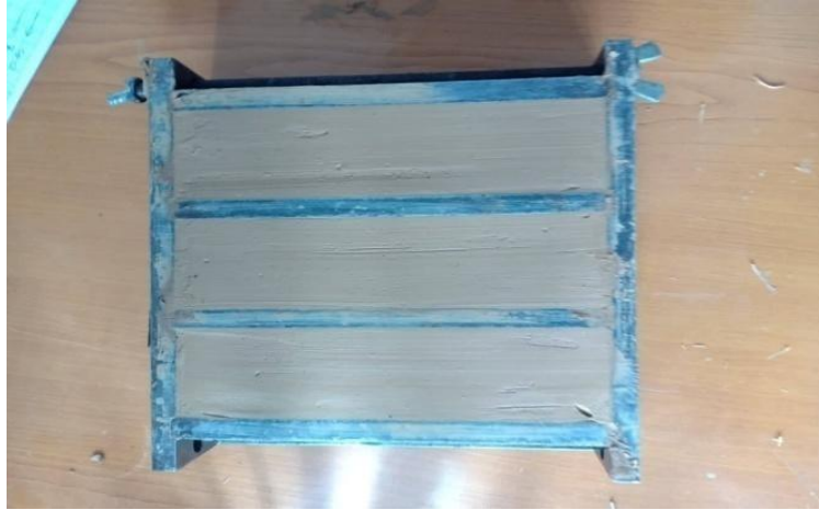
Figure 36 : Façonnage des briques
