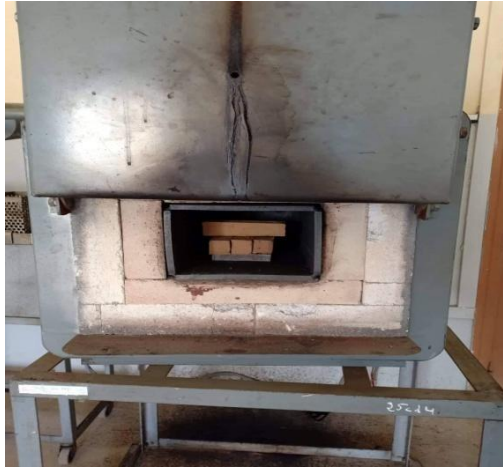
Figure 39 : Cuisson de briques au four du Hall Technologie (photo prise)
