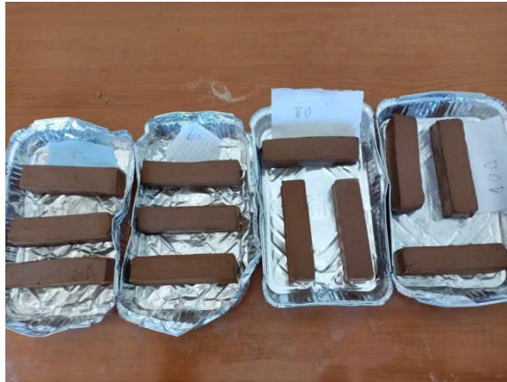
Figure 14 : Epreuves aux différents pourcentages d'argile
