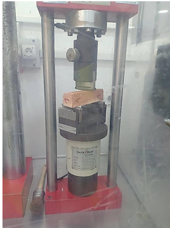
Figure 15 : Essai de flexion (photo prise au laboratoire d'une cimenterie à Bouira)
