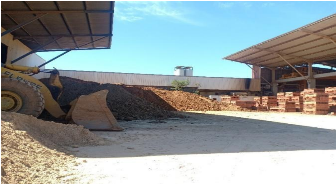
Figure 9 : Stock d'argile concassé (photo prise)
