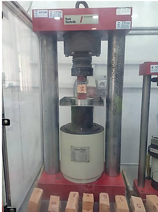
Figure 16 : Essai de compression (photo prise au laboratoire d'une cimenterie à Bouira)
