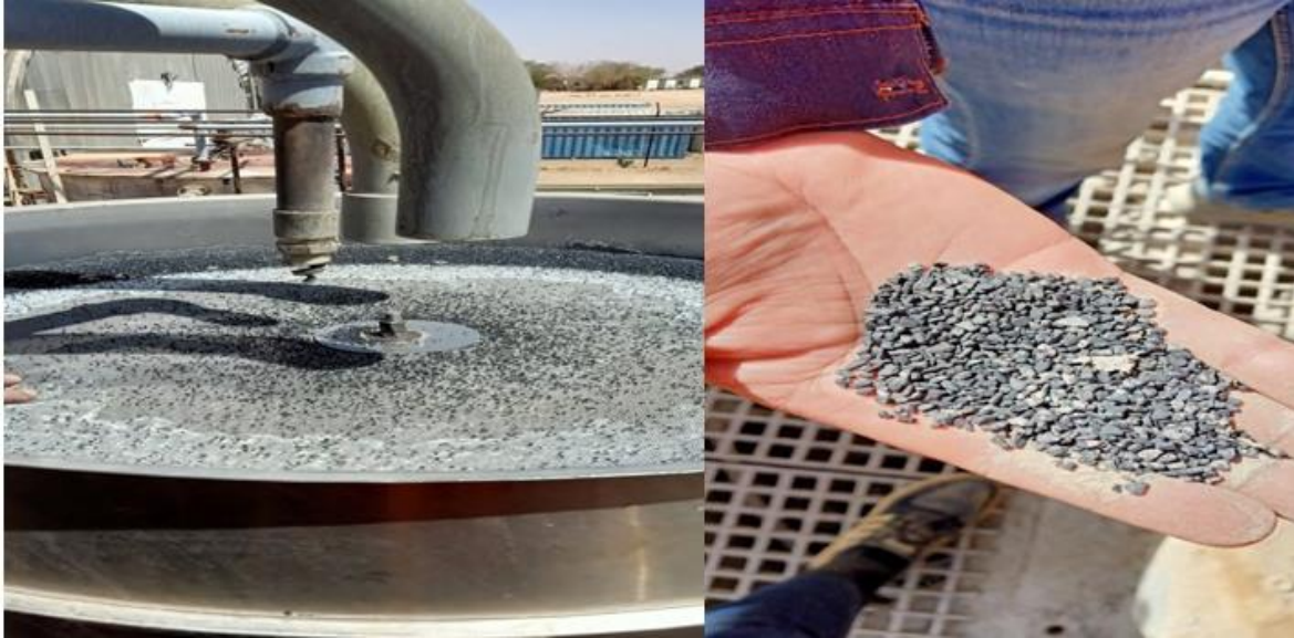
FigureII.30: Tamis vibrant et le charbon actif. [Photo prise]
