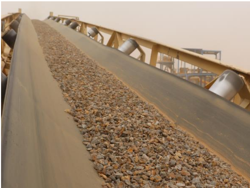
Figure III.5 : Granulométrie des roches après le débitage. [Photo prise]
