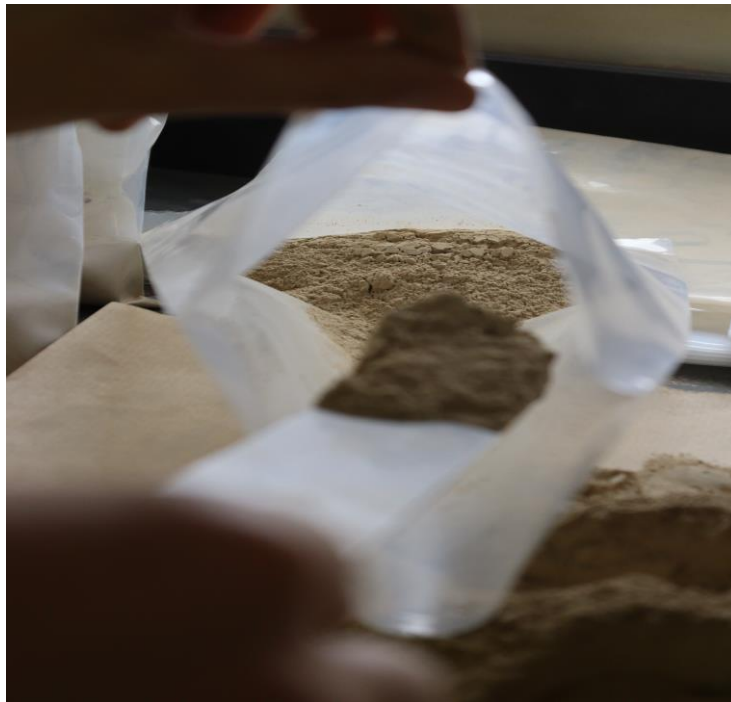
Figure III.8 : L'échantillon après le Broyage. [Photo prise]
