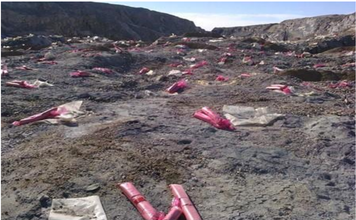
Figure II.1: Position des trous de tir avant l'implantation des explosifs. [14]
