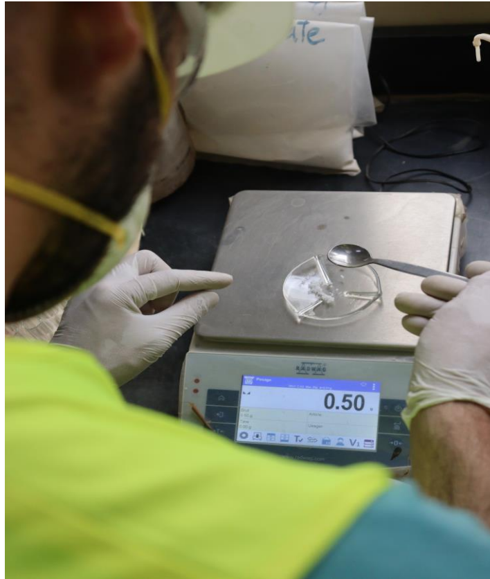
Figure III.15 : La soude caustique (NaOH) dans une balance électronique. [Photo Prise]
