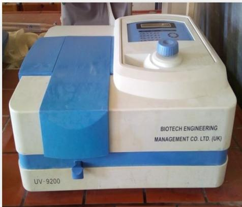
**Photo N°09 : Spectrophotomètre**
