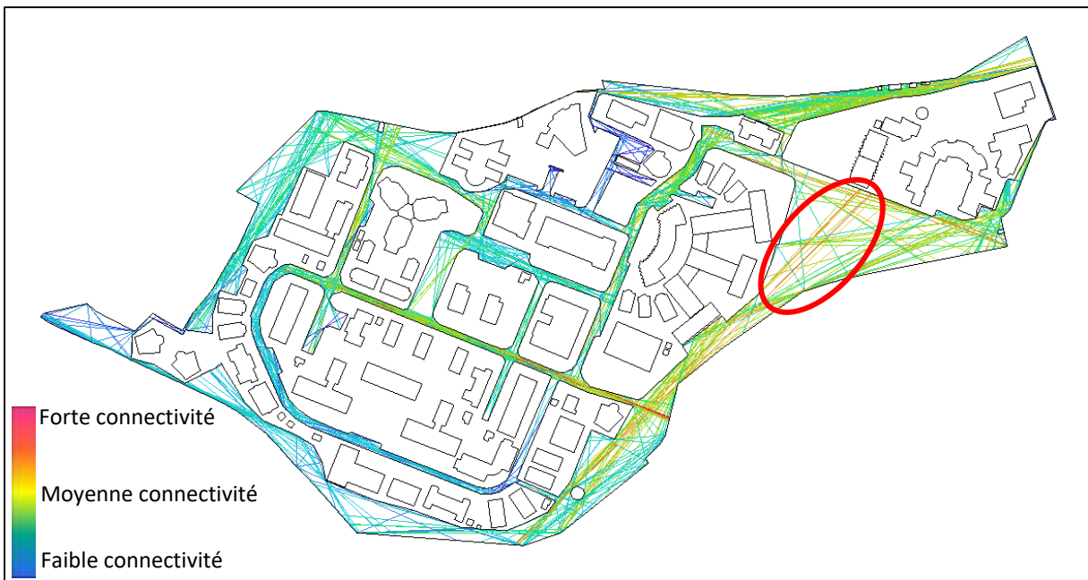
Figure 54: carte de résultat de connectivité de l'analyse axiale du campus targa ouzemour, traité par : (Auteur, 2023)
