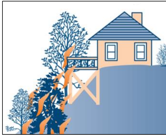
Figure 14 : Le terrain accidenté et la présence de combustibles lourds en bas de la pente sont des facteurs de risque pour cette maison
