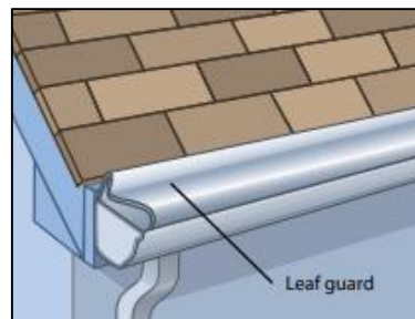
Figure 40 : Les pare-feuilles permettent à l'eau de pluie de pénétrer dans la gouttière tout en empêchant les débris combustibles de sortir.
