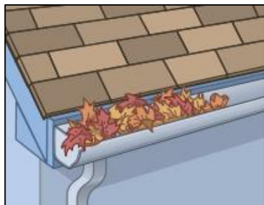
Figure 39 : Les débris accumulés dans les gouttières peuvent causer des incendies en entraînant l'inflammation du toit.
