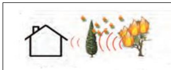
Figure 8 : interception des brandons et de la chaleur radiante par la végétation ornementale
