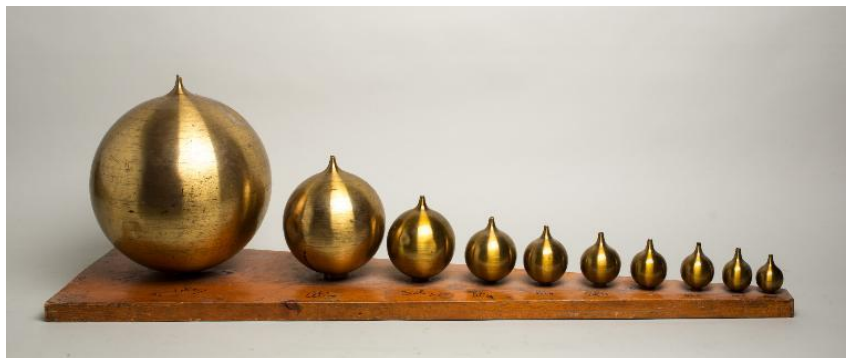
Figure 2-5: Résonateur de Helmholtz. (Source : atrimoine.auvergnerrhonealpes.fr).
