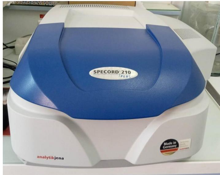
**Figure 20 : Spectrophotomètre pour la lecture de la densité.**
