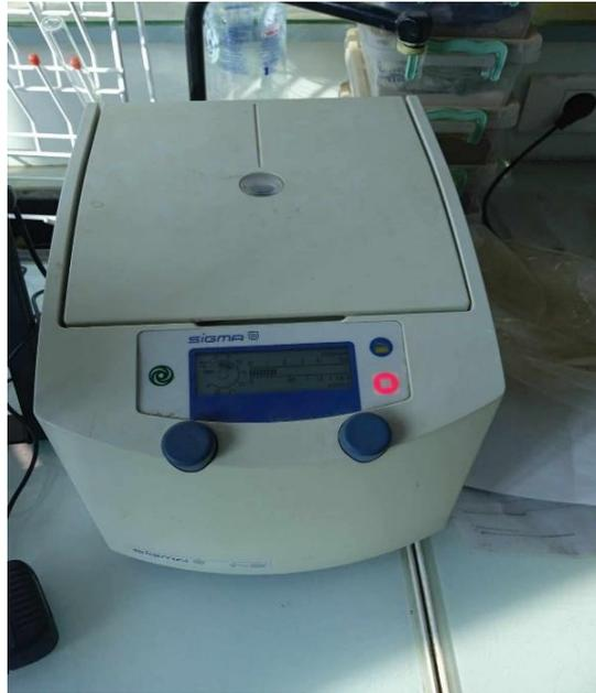
**Figure 18 :** centrifugeuse utiliser lors de la séparation de surnageant et le culot.
