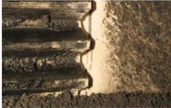
**Figure 12 :** L'usure de dentures d'engrenages [7]
