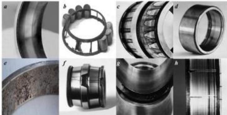
**Figure 20** : Quelques défaillances affectant les roulements [3] a- Usure généralisée b- Cage détériorée c- Corrosion d- Présence de cratères e- Écaillage f- Fissure et cassure g- Grippage h- Traces
