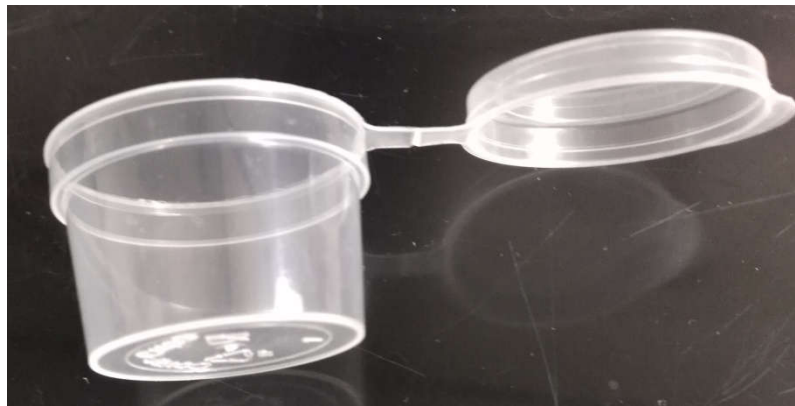
Fig.3.47. Photo d'un moule en plastique utilisé pour la préparation des blocs de résine
