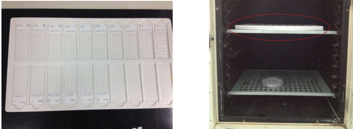
Fig.3.42. A gauche, photo de lames en position à plat sur un porte-lames; à droite, photo des portes- lames incubées dans une étuve à 37°C.
