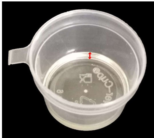
Fig.3.49. Photo d'un moule rempli à 1/5 de résine (flèche rouge) pour servir de support au dard
