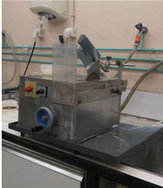
Fig.3.51. Photo d'une scie liée à un moteur électrique utilisée pour la réalisation des coupes du dard
