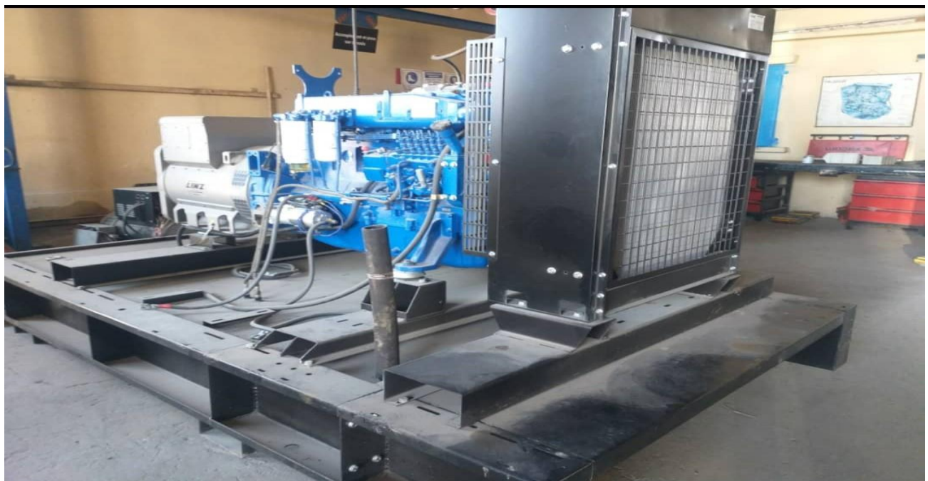
Figure I.4 un châssis et un groupe électrogène
