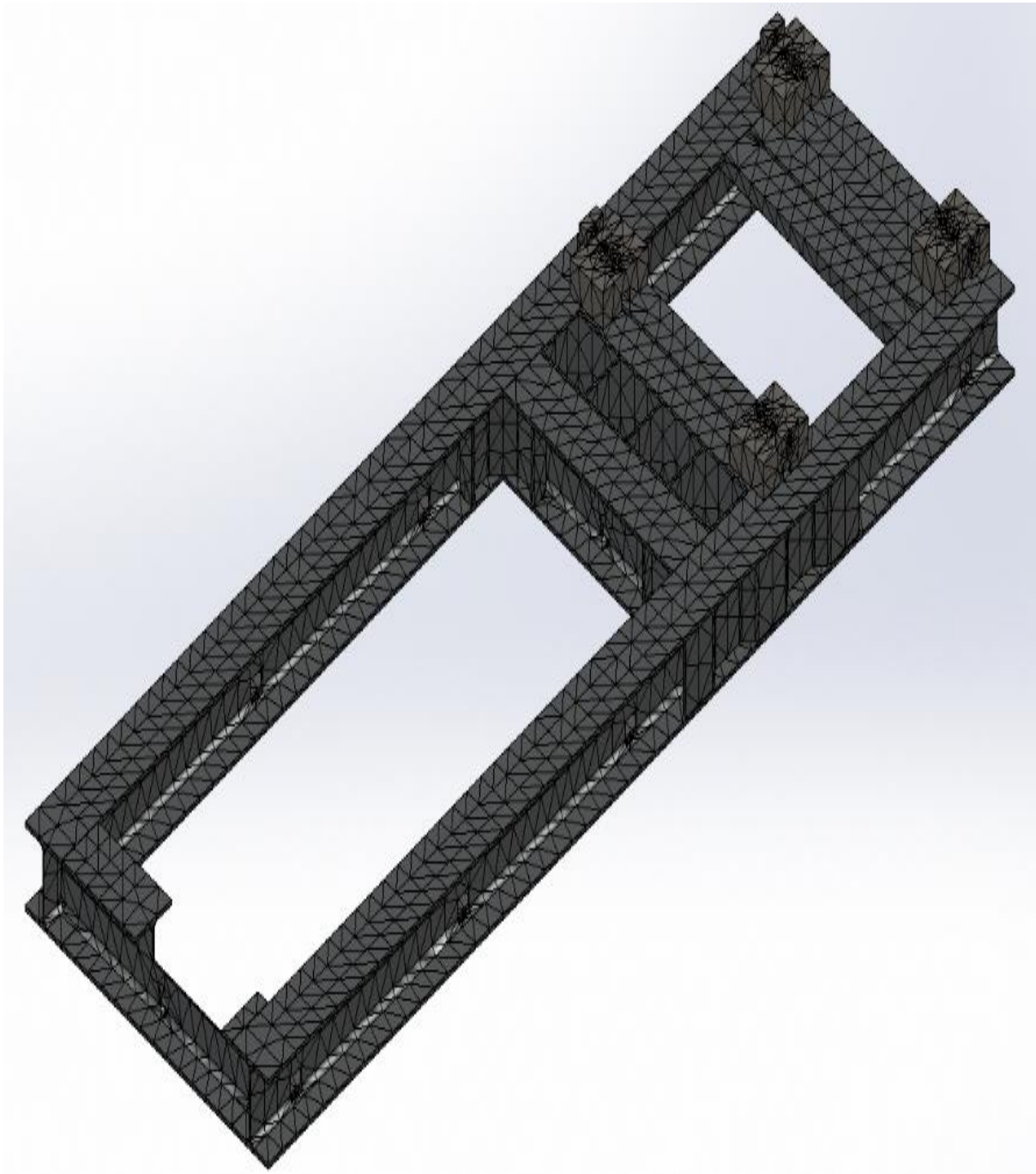
Figure III.15. Application du maillage après le renforcement
