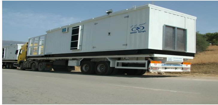
Figure I.3 un groupe électrogène de 1000 KVA sur la remorque
