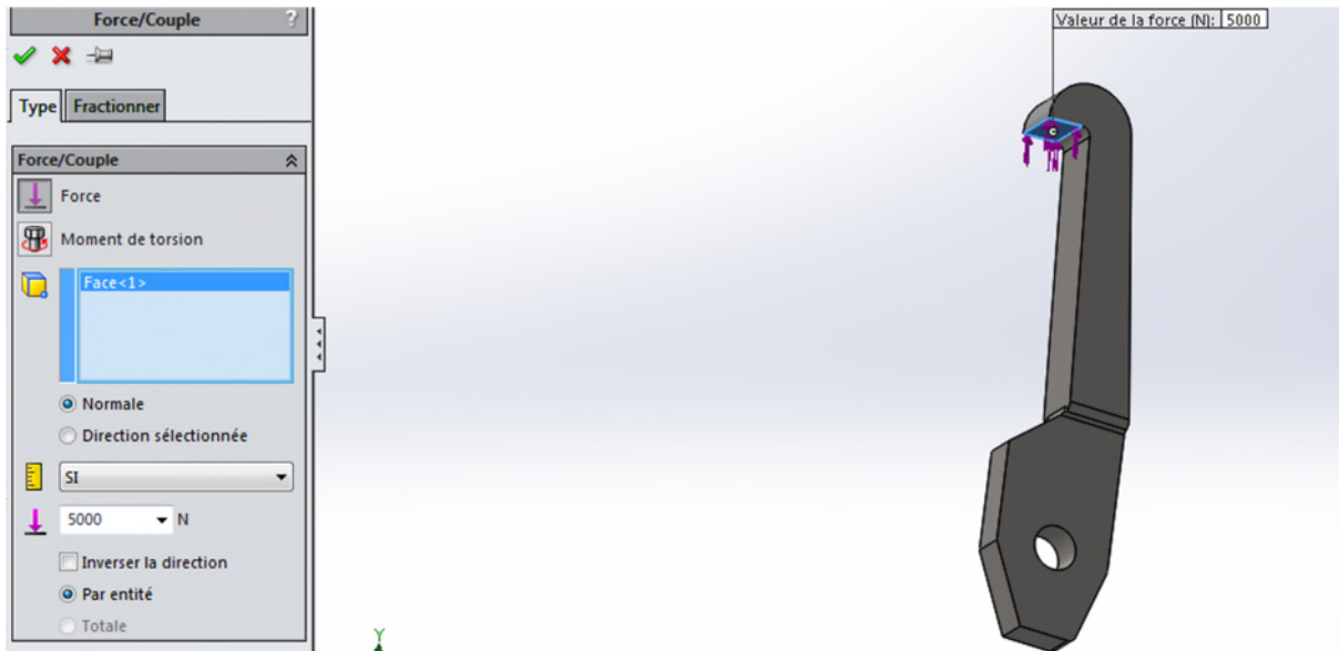
Figure 31 : Application du chargement sur la griffe
