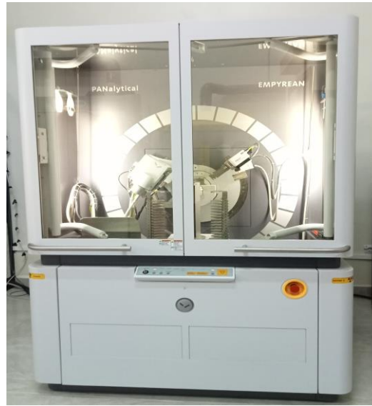
Figure III.12 : Un diffractomètre de type Panalytical X'pert Pro.
