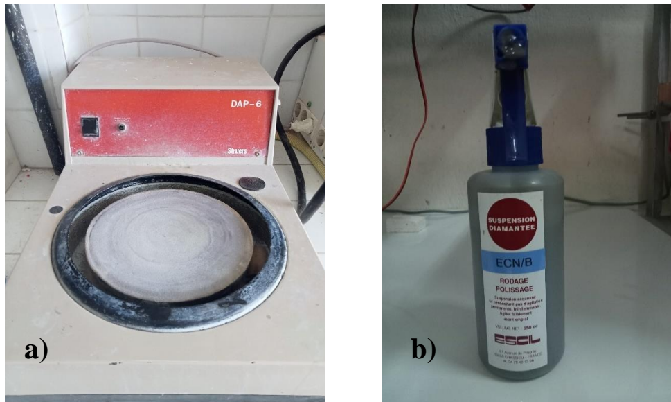
Figure III.9 : a) Polisseuse de finition, b) Pâte diamantée utilisé.
