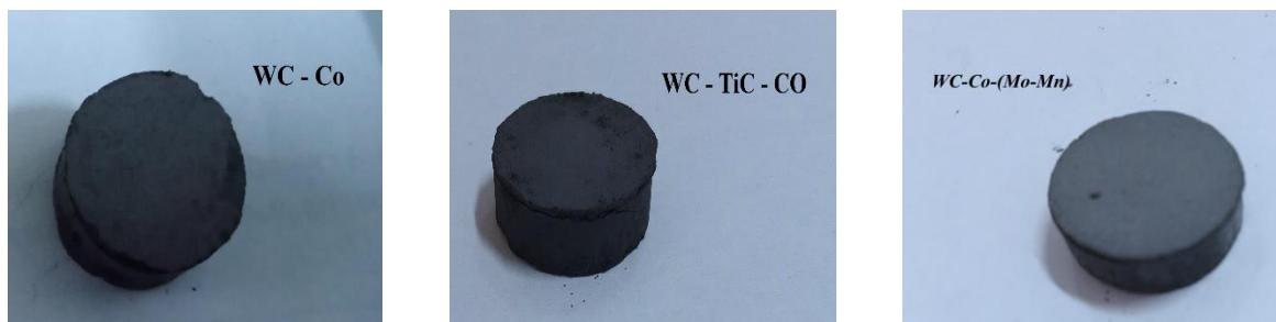
Figure III.5: Représentation des pastilles des trois mélanges utilisés, (WC-13%Co, WC-10%TiC-13%Co, WC-13%Co-10%(Mo-Mn)).
