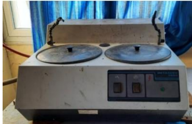
Figure III.8 : Polisseuse de marque METASERV 2000.
