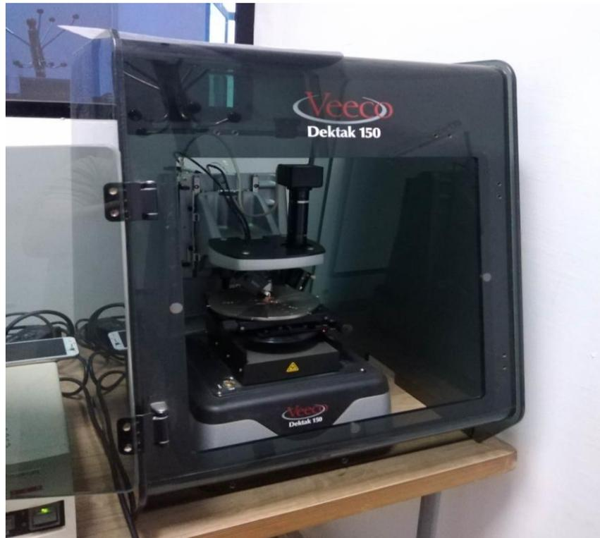
**Figure II.8** : Profilomètre optique
