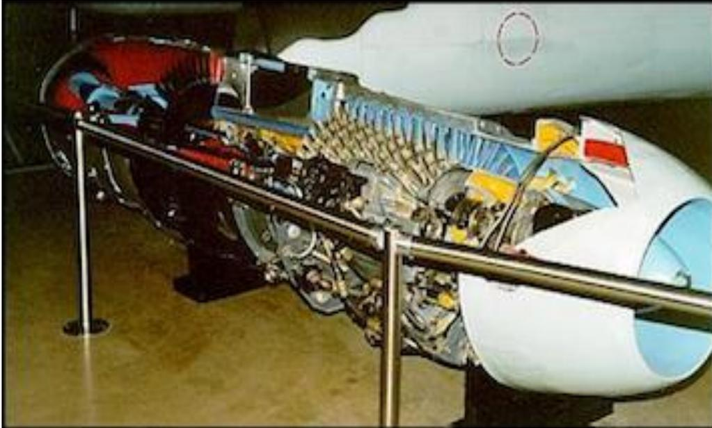
**Figure I.11 :** Premier turboréacteur aéronautique avec des composants superalliage base Nickel
