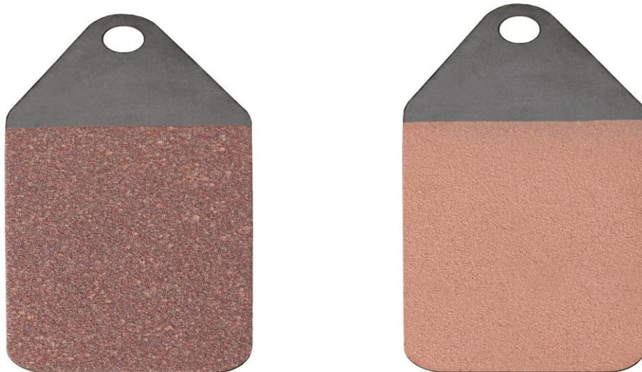
**Figure II.1** : Image d'un échantillon obtenu après projection thermique
