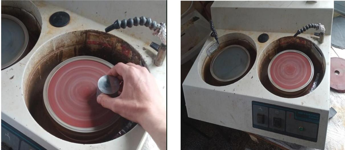
**Figure III. 6 :** Essai de polissage réalisé avec une polisseuse mécanique
