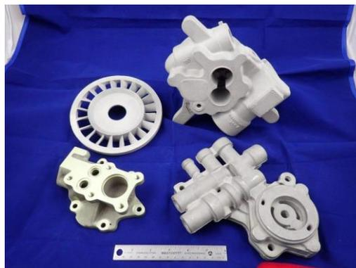
**Figure I. 9** : Petites pièces d'aluminium moulées au sable
