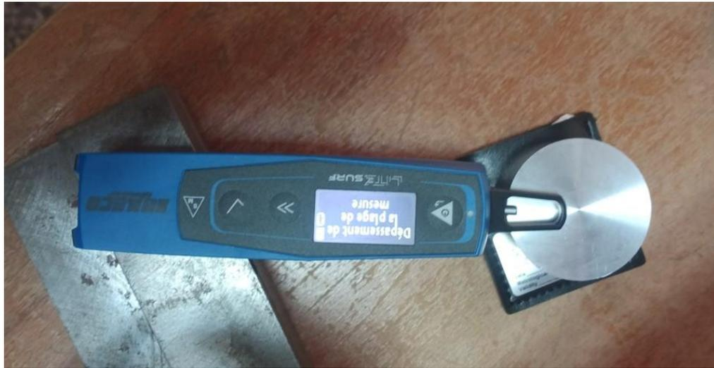
Figure III. 9 : Rugosimètre marque LiteSURF-SOMECO
