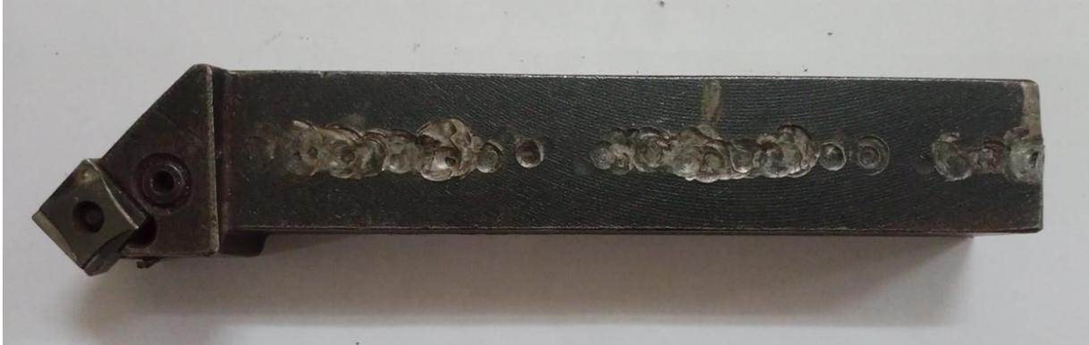
**Figure III. 5 :** Outil de coupe à plaquette en carbure métallique amovible.
