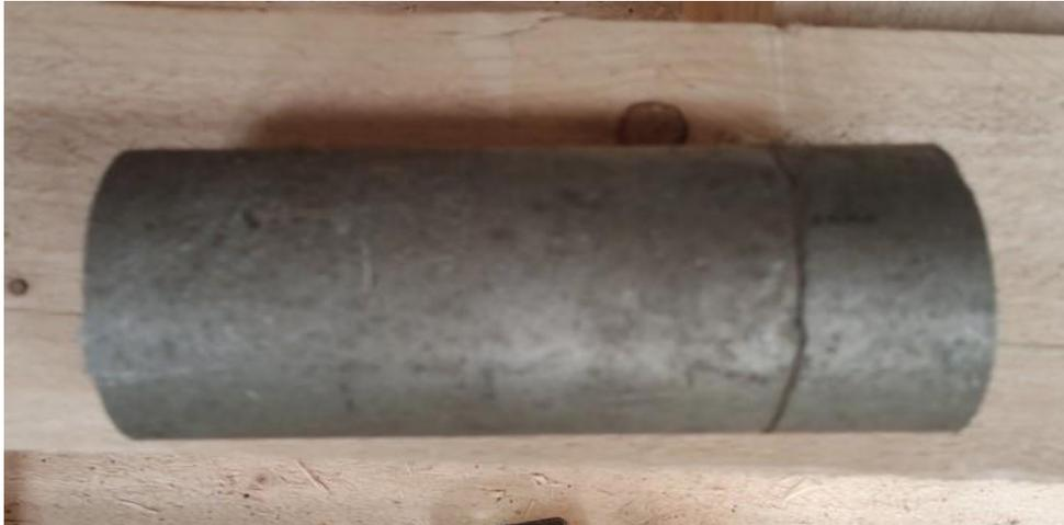
**Figure III. 2 :** Cylindre plein d'aluminium (AL moulé)
