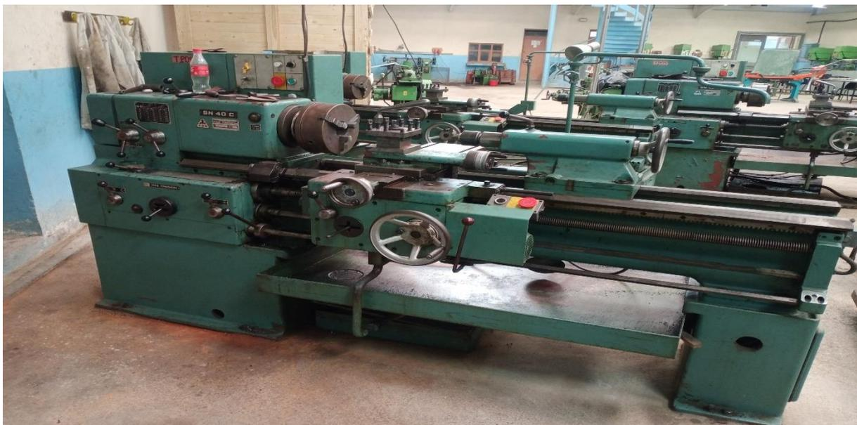
**Figure III. 4 :** tour conventionnel type SN 40 C
