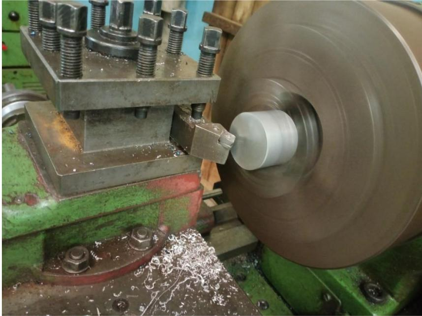
**Figure III. 3 :** opération de dressage réalisé
