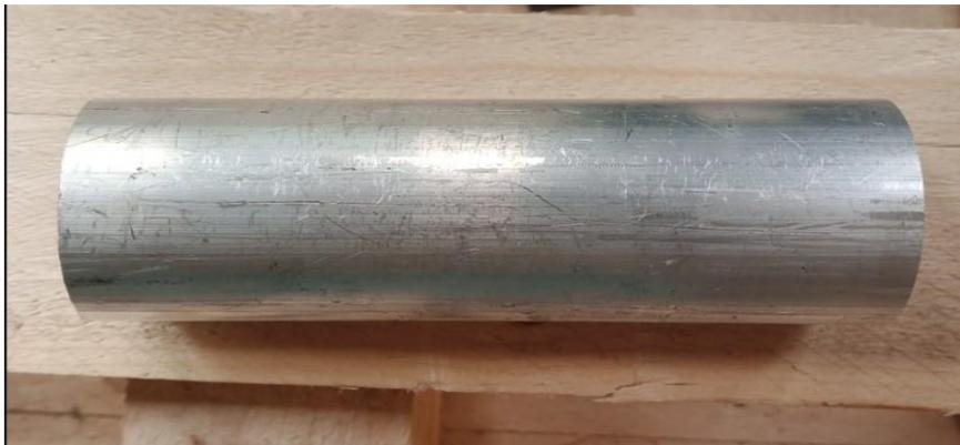
**Figure III. 1 :** Cylindre plein d'aluminium (Al-Cu2Mg)
