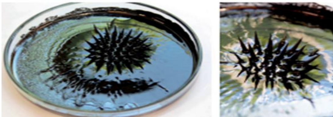
Figure I-1 : Instabilité magnétique de pic lors de l'approche d'un aimant dans le cas d'un ferrofluide organique surfacé [1].
