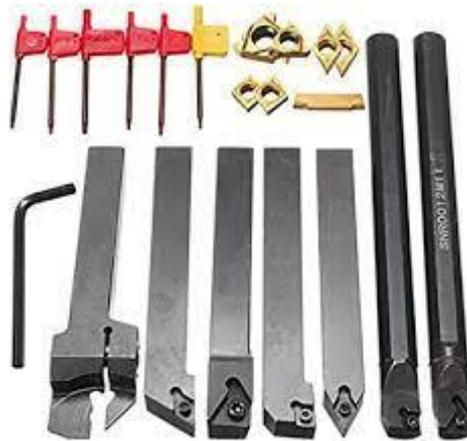
Figure II.10 : Outillage de tournage
