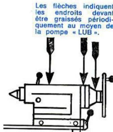
**Figure II.26** : Système de lubrification de la poupée mobile
