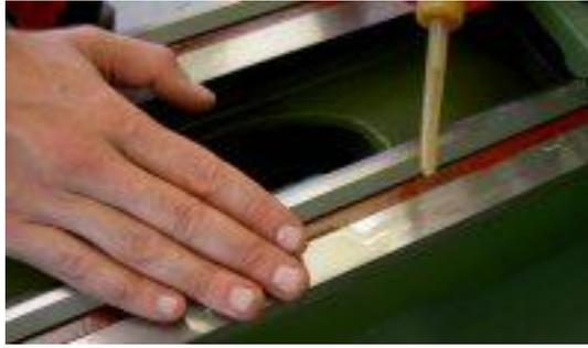
**Figure III.9 :** Lubrification manuelle des glissières avec une graisse
