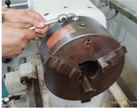
Figure II.21 :Montage et démontage du mandrin
