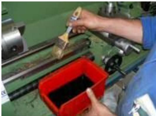
**Figure III.8** : Lubrification manuelle des glissières avec l'huile
