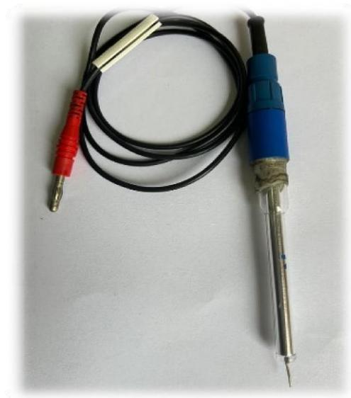
**Figure III.4.** contre-électrode
