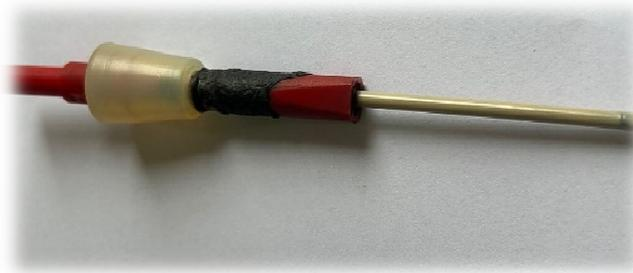
Figure III.2. l'électrode de travail
