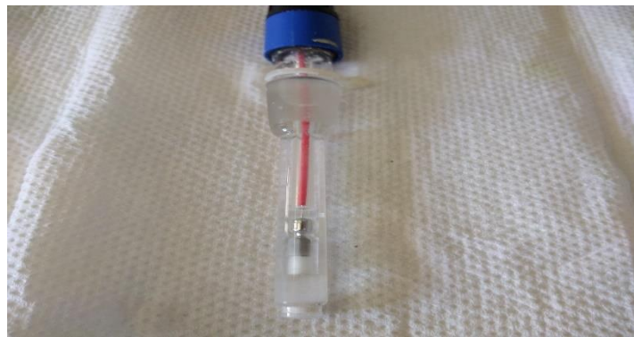
Figure II.5 : Électrode de référence (ECS).
