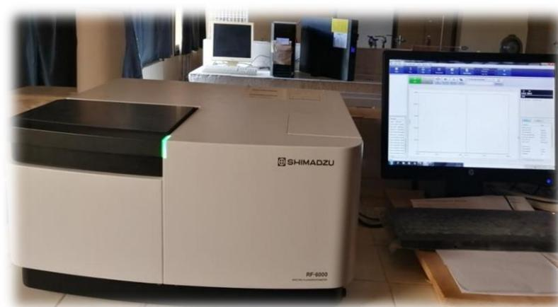
**Figure II.13.** Spectrophotomètre de luminescence.
