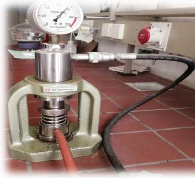
Figure II.7. Presse hydrostatique
