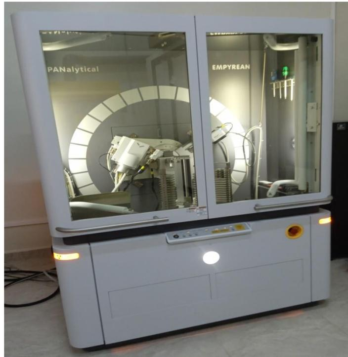
**Figure II.3.** Diffractomètre utilisé pour la diffraction des rayons X.
