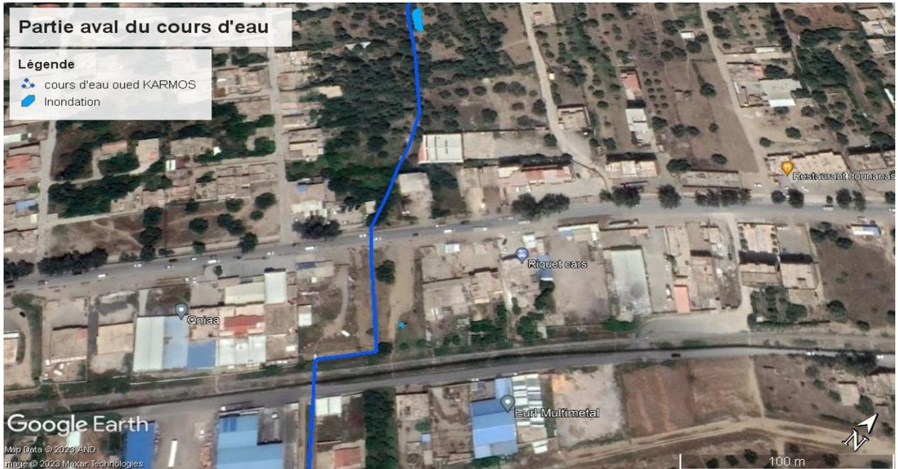
**Figure (III.8) :** Image satellitaire du Google EARTH illustrant les zones d'inondation de la partie aval d'Oued KERMOUS pour  $T=100$  ans.
