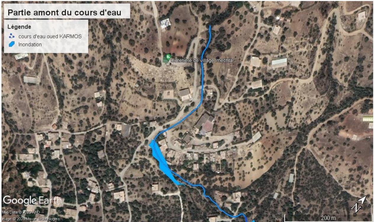
**Figure (III.6) :** Image satellitaire du Google EARTH illustrant les zones d'inondation de la partie amont d'Oued KERMOUS pour  $T=100$  ans.
