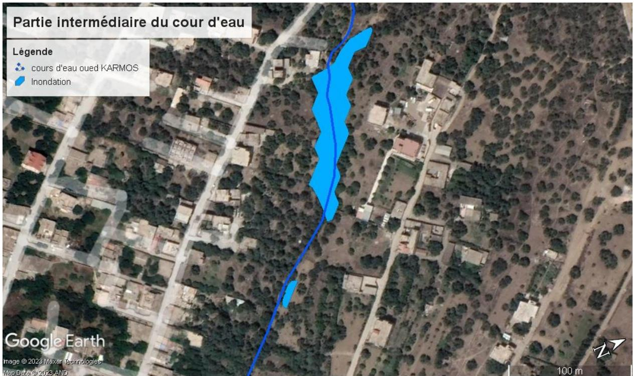
**Figure (III.7) :** Image satellitaire du Google EARTH illustrant les zones d'inondation de la partie intermédiaire d'Oued KERMOUS pour  $T=100$  ans.
