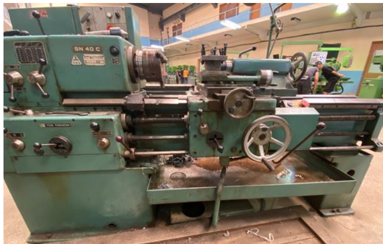
Figure IV.1: Machine-outil tour du Hall de Technologie.
