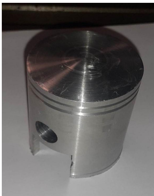
Figure IV.33 : Photo du piston fini.
