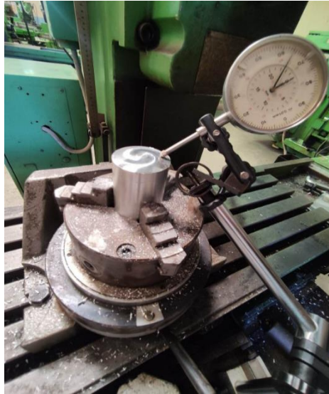
Figure IV.21 : Rendu de la pièce après le fraisage de la tête du piston.
