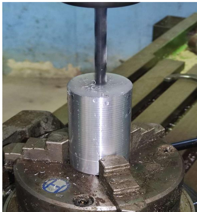
Figure IV.17 : Perçage de l’intérieur du piston avec un foret de 5mm de diamètre. Pour faire la finition, nous avons fixé la pièce sur un diviseur et continuer le perçage avec une fraise de 20mm de diamètre sur 44mm. La fraise a été utilisée pour la finition grâce à sa précision.
