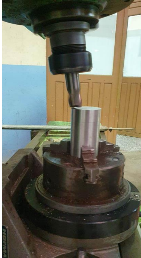
Figure IV.19 : Inclinaison de la broche de la fraiseuse de 8^\circ avec une fraise de 20mm de diamètre.
