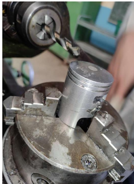
Figure IV.22 : Prise de mesure du centre du trou de l'axe de la bielle suivant l'ancien piston.
