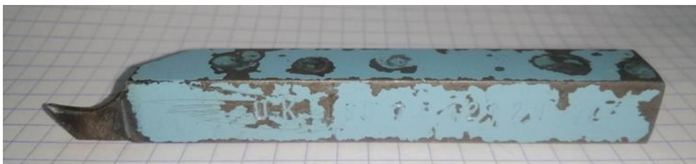
Figure IV.29 : Outil en ARS de 1mm rénové avec la meuleuse.
