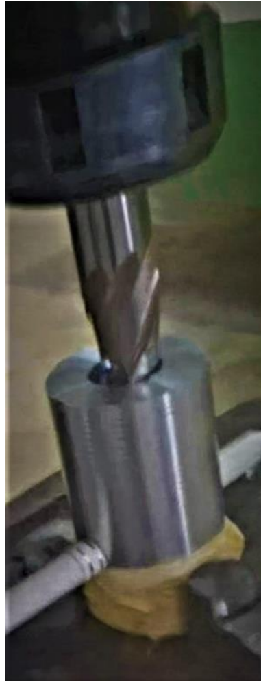
Figure IV.18 : Perçage de finition avec la fraise de 20mm de diamètre.
