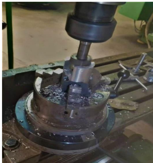
Figure IV.26 : Perçage avec la fraise en T de 30mm de diamètre.
