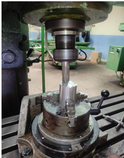
Figure IV.20 : Fraisage de la tête du piston avec une fraise de 20mm de diamètre.
