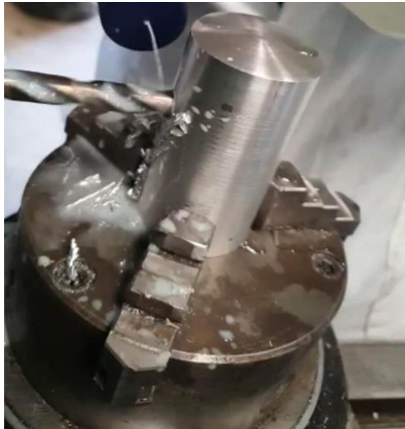
Figure IV.23 : Perçage du trou de l'axe de la bielle avec un foret de 10mm en ébauche.
