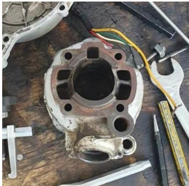
Figure III.2: Chemise du moteur de la moto ( \varnothing = 43\text{mm} ).
