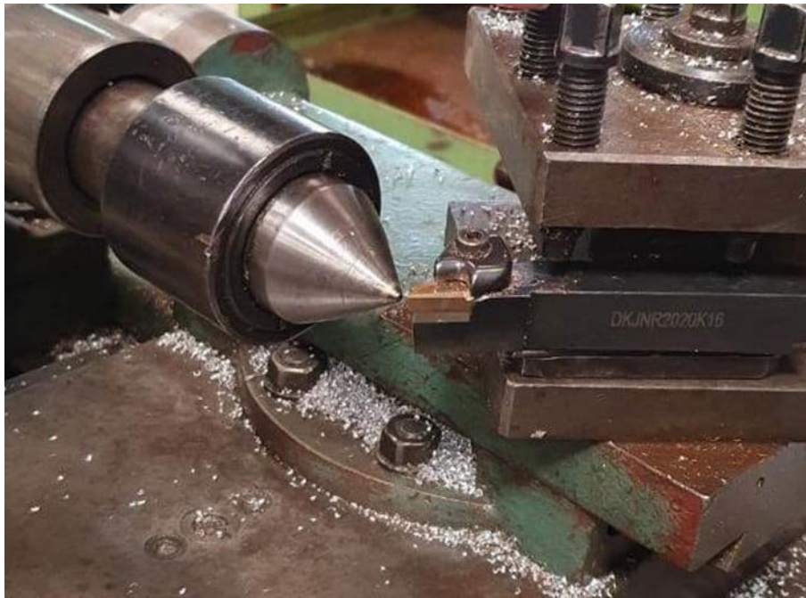
Figure IV.12 : Centrage de l'outil de la machine-outil tour grâce à la poupée.
