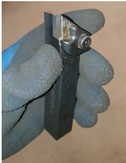
Figure IV.7: Outil de coupe et plaquette utilisés pour le tournage de la pièce.
