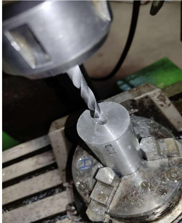
Figure IV.16 : Pièce marquée au centre avec un foret à centrer avant d’être percée par un foret de 5mm de diamètre.
