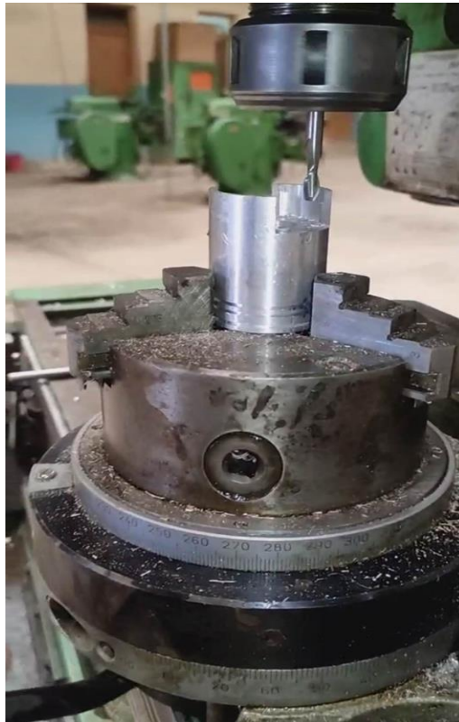
Figure IV.27 : Fraisage de finition des jupes avec une fraise en bout de 4mm de diamètre.
