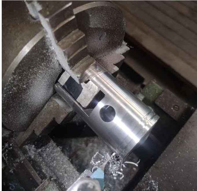
Figure IV.30 : Tournage de la pièce avec l'outil en ARS de 1mm pour les gorges de segment.
