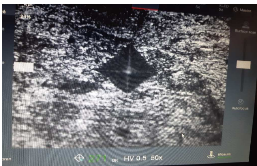
Figure 61 : Empreinte de l'essai de dureté sur l'acier 42CD4
