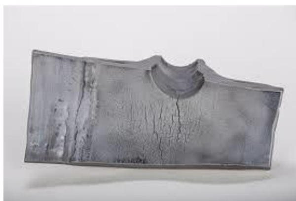
Figure I.12 : Corrosion sous contrainte.
