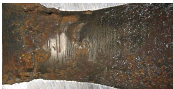
Figure I.13 : Corrosion sous contrainte en présence d'une pression partielle de sulfure d'hydrogène.
