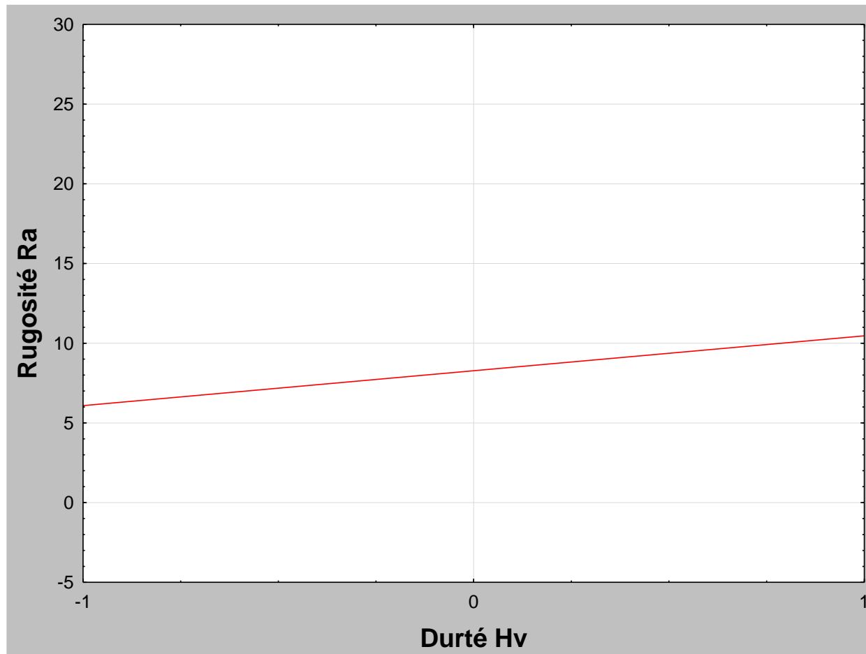
Figure IV. 10 : Modélisation de l'effet de (Hv) par rapport à la rugosité Ra.
