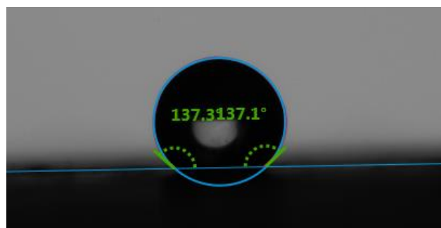
Figure III.14 : La goutte d'eau capturée par l'appareil Drop Shape Analyzer DSA30 KRÜSS GmbH.
